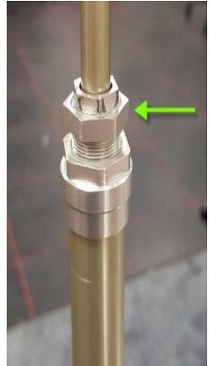
**Étape 4** | Vissez l'écrou d'ajustement (13MM) jusqu'à ce que le contre-écrou soit au niveau de la tête d'étanchéité.
