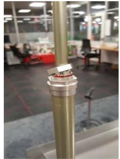
**Étape 7** | Vissez le contre-écrou (18MM) à un couple de 8NM.
